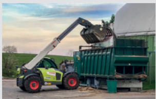
Füttern der Biogasanlage mit dem Teleskopplader
